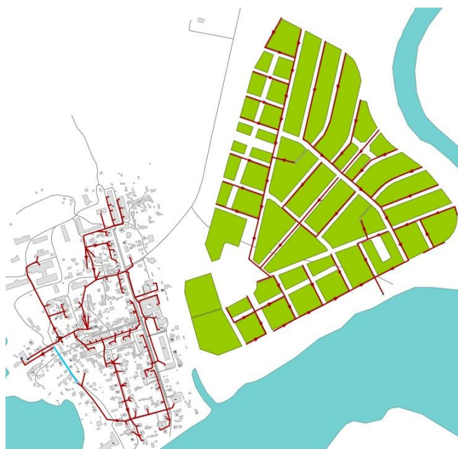
Рисунок 9. Перспективное положение централизованной системы водоотведения в технологической зоне водоотведения с. Чеускино сельского поселения Сингапай
